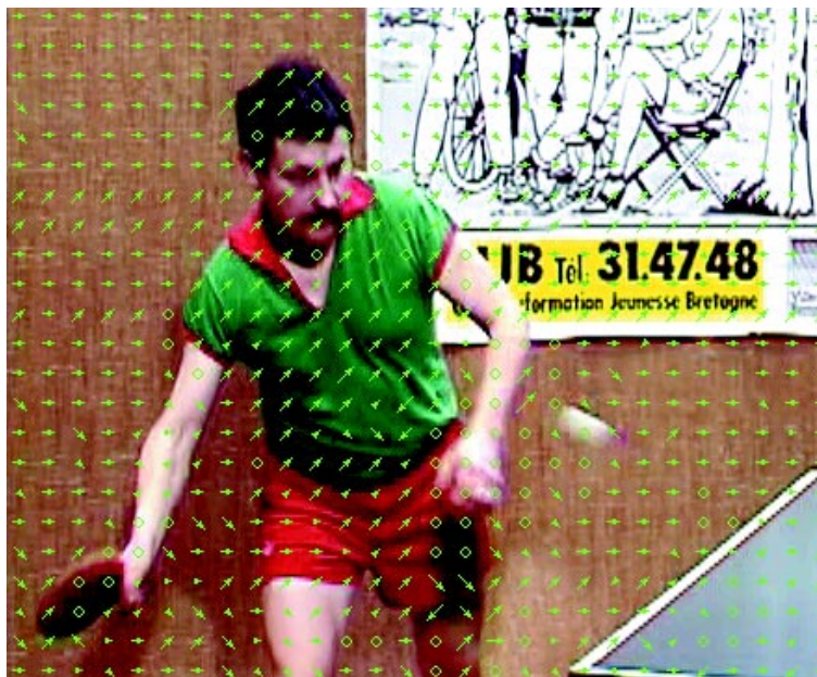
Bild 5: Darstellung der Bewegungsvektoren von prädizierten Bildern (B und P) als Einblendung in das dekodierte Bild
